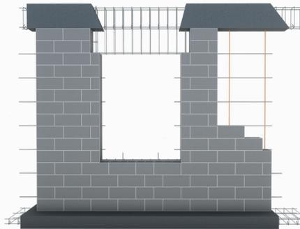
Diseñado para construir paredes hasta de cinco niveles, utilizando bloques de concreto modular: 15 cm de ancho, 20cm de alto y modulados de 45, 30 y 15 cm de longitud.
