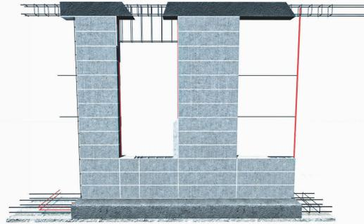
Diseñado para construir paredes de 1 nivel o para utilizar en segundos niveles, utilizando bloques de concreto modular: 12 cm de ancho, 20cm de alto y modulados de 90, 75, 60, 45 y 30 cm de longitud.
