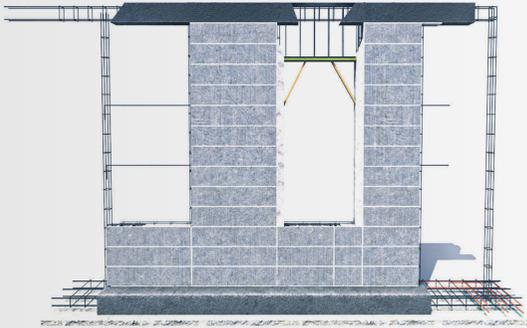
Diseñado para construir paredes hasta de tres niveles, utilizando bloques de concreto modular: 15 cm de ancho, 20cm de alto y modulados de 90, 75, 60, 45 y 30 cm de longitud.
